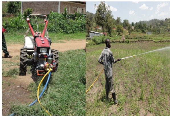
Power tiller yambaye impobo ikoreshwa mu gutera umuti wica udukoko twangiza imyaka.
