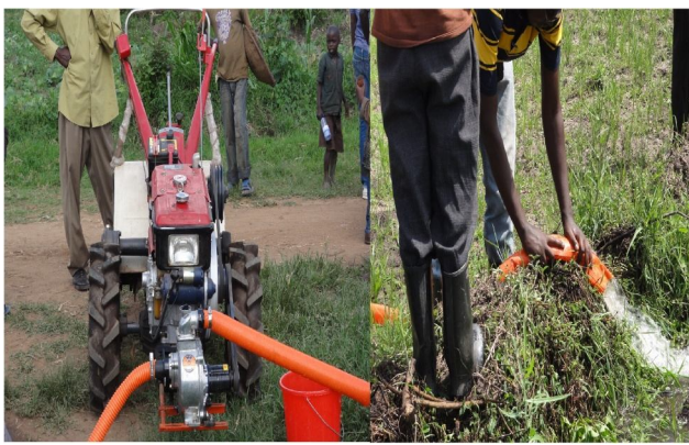
Power tiller iriho impombo ikoreshwa mu kuvomerera imyaka
